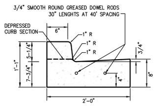
COMBINED CONCRETE HIGH-BACK CURB AND GUTTER
